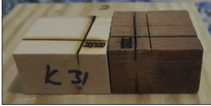
Şekil 2.2. Serbest su ve bağlı su durumunda uygulanan lazer kesim görüntüsü
