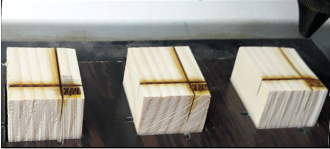
Şekil 2.1. Ahşap masif malzemelerin tam kuru haldeki lazer kesim örnekleri
